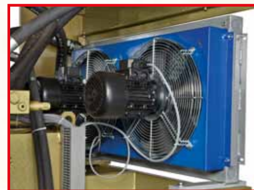
Raffreddamento ad aria forzata per centralina idraulica. Hydraulic oil air cooling system.
