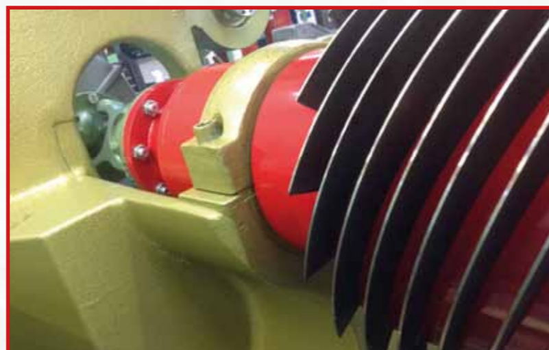
Trasmissione diretta del cilindro a lame con giunto cardanico. Blade cylinder direct drive with universal joint.
