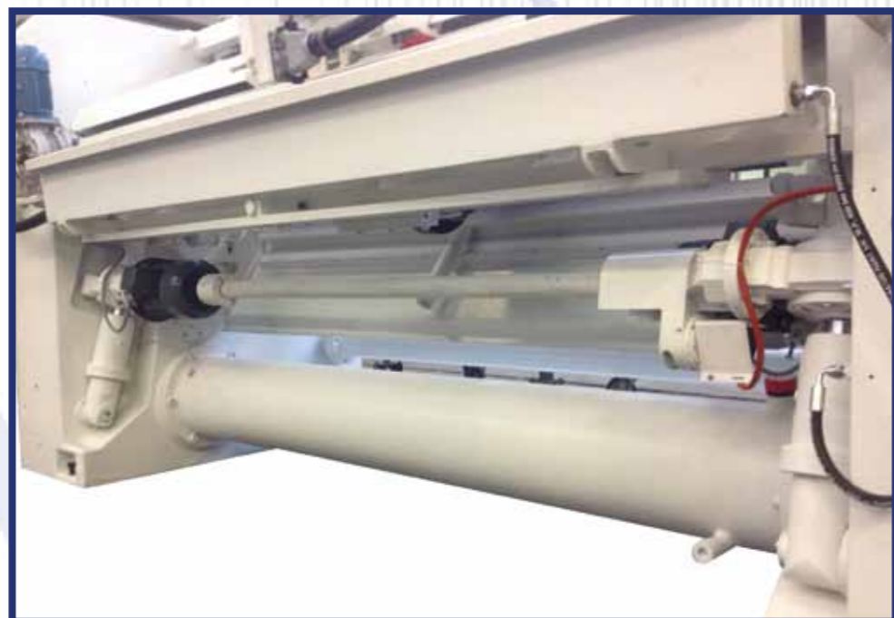
Trave affilatore e cilindro a lame con movimento su viti per la regolazione dello spessore Screw movement grinder beam and blade cylinder for thickness adjustment
