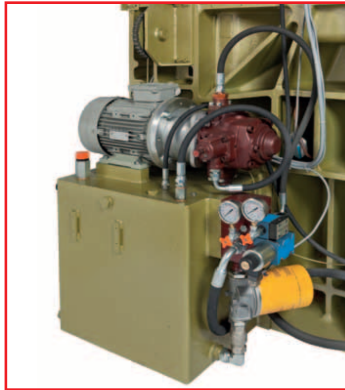
Centralina idraulica. Hydraulic control.
