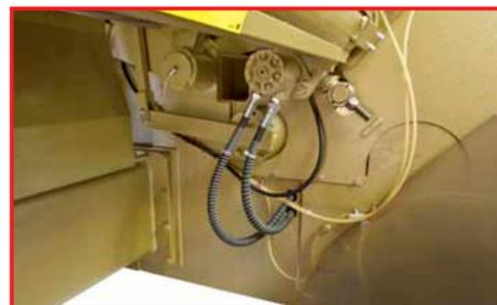
Motore idraulico cilindro stendipieghie.
