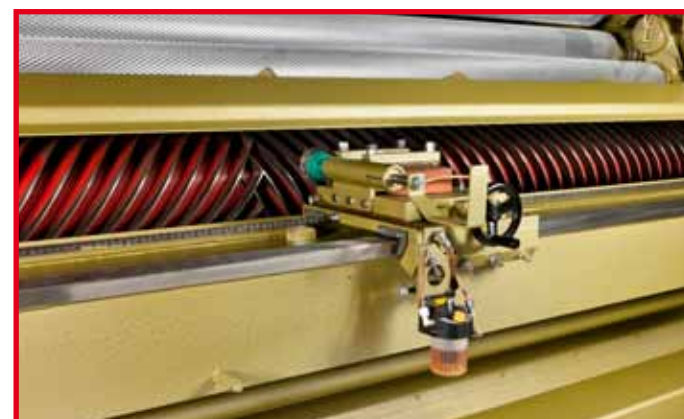
Carrello affilatore con spazzola in acciaio.
